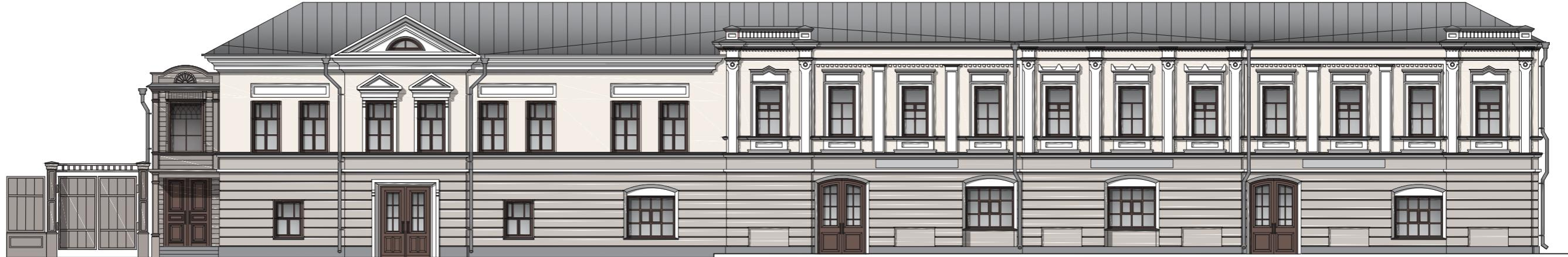
1. Ремонт цоколя здания. Выполнить расчистку цоколя пристройки для определения состояния конструкции и дальнейшего выбора способа технологии производства штукатурных работ. Новую отделку цоколя выполнять цементной штукатуркой для фасадных работ на основе портландцемента, с фракционированным песком, водоудерживающими и другими добавками, улучшающими их эксплуатационные характеристики. Окраску производить минеральными красками, цвет по каталогу NCS S 2500-N.
